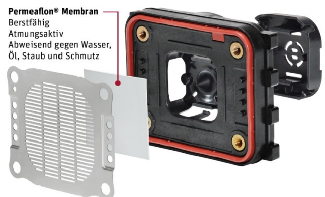
Abb.1: Entgasungseinheit für Hochvoltpeicher Quelle: MANN+HUMMEL GmbH
